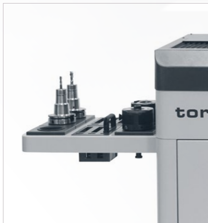
Die Adapterplatten sind auf einer speziellen Halterung direkt am Gerät in Reichweite untergebracht.
