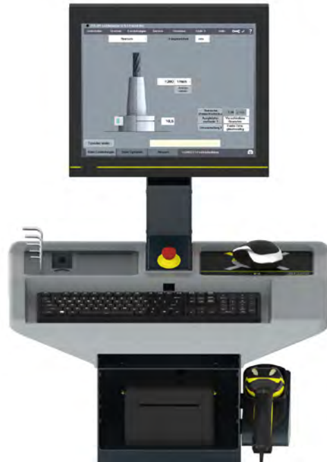
Messgerätesteuerung mit ZOLLER-Bediensoftware am »toolBalancer« mit »cockpit«
