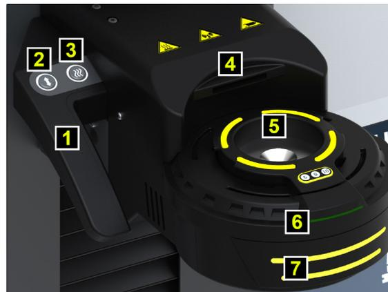
14 kVA-Induktionsspule mit Abschirmscheiben mit »shrinkbyLight«-Bedienführung
