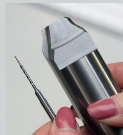
Für effiziente, produktive und wirtschaftliche Fertigung: Die Spezialisten bei Nikolaus entwickeln und schleifen ausgeklügelte Sonderwerkzeuge von 0,1 bis etwa 32 mm Durchmesser.
