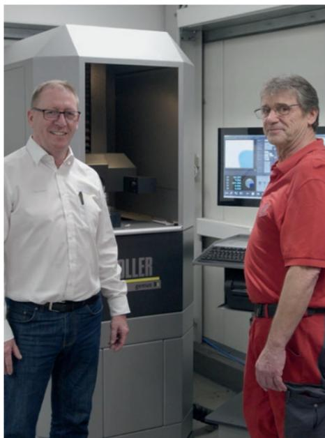
diesem Gerät schätzen die Spezialisten die besonders einfache Bedienung. Darüber hinaus erweist es sich als sehr flexibel. Die Software »pilot« enthält Messzyklen für eine Vielzahl an Geometrien. Diese wählt der Bediener lediglich durch Antasten des passenden Symbolbilds (Icons) auf dem großen
