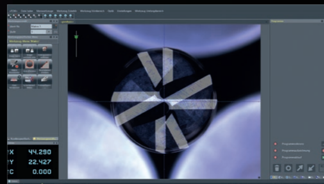
Positionieren des zu vermessenden Werkzeuges zum Referenzbild
