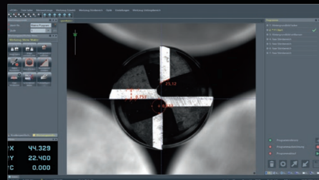
Start des automatischen Messvorgangs im Makroprogramm
