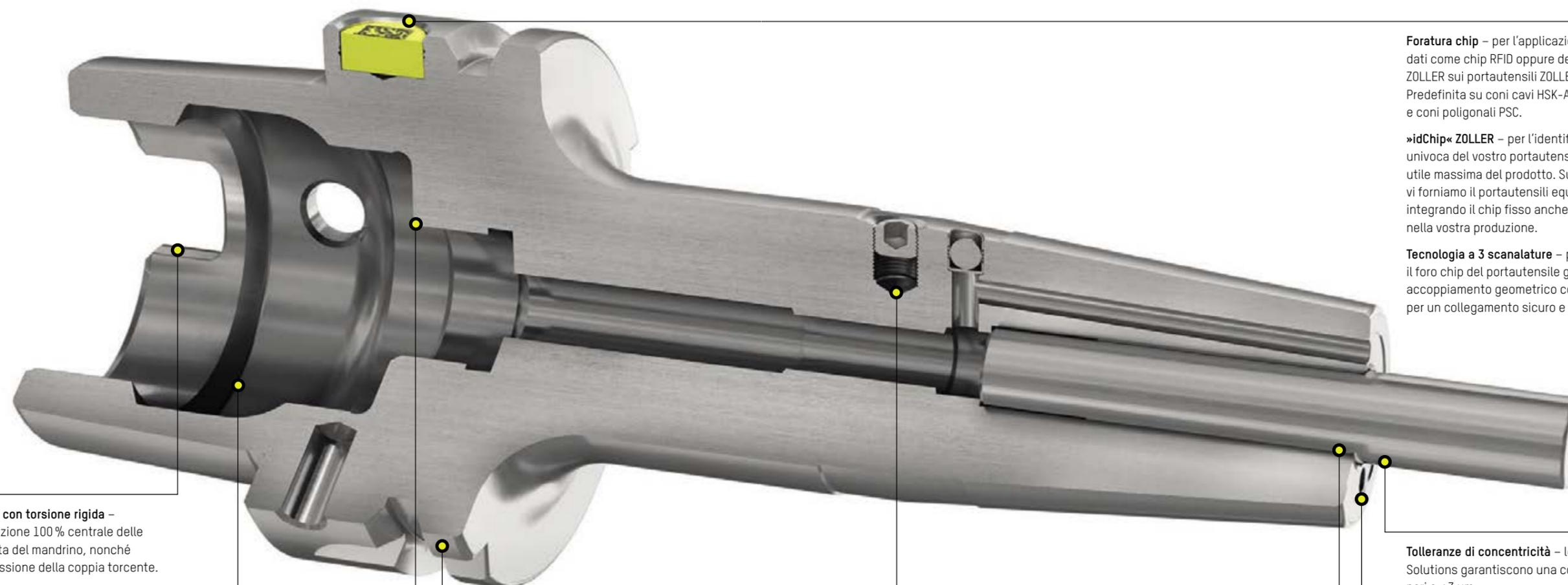
**Cave di trascinamento con torsione rigida** – garantiscono una posizione 100 % centrale delle cave, una sede perfetta del mandrino, nonché un'eccezionale trasmissione della coppia torcente.
