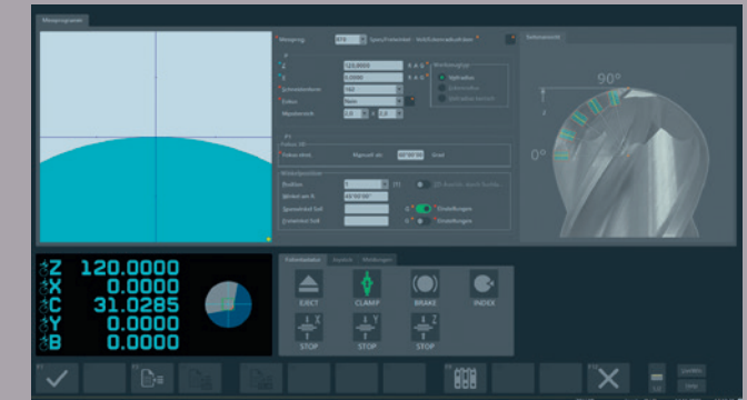
Spanwinkel an Radiusfräsern – ermittelt im Radiussegment den Spanwinkel unter den vorgegebenen Winkeln. Geeignet für Gesenk-, Eck- und Vollradiusfräser.
