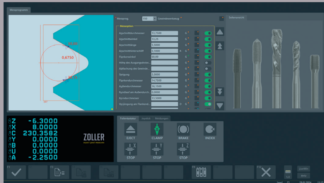
ZOLLER-Gewindemessprogramm – für metrische ISO, ANSI und Whitworth-Rohrgewinde
