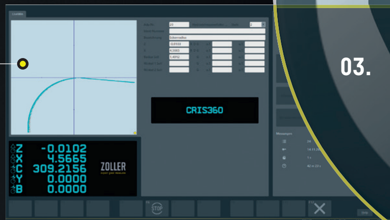
Aktive Messung bspw. Wirkkontur Eckradius
