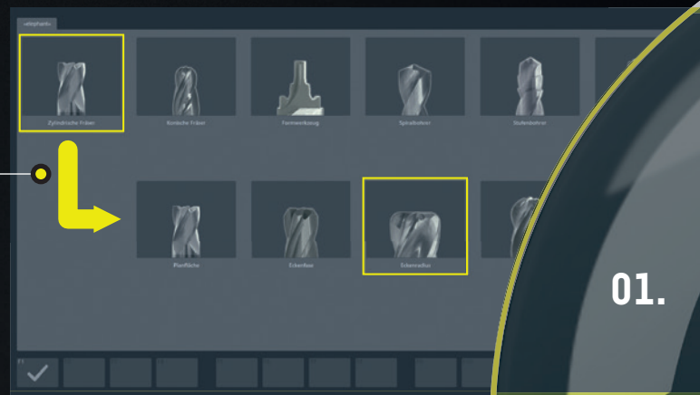
Auswahl Werkzeugtyp bspw. Schaftfräser > Schaftfräser mit Eckradius
