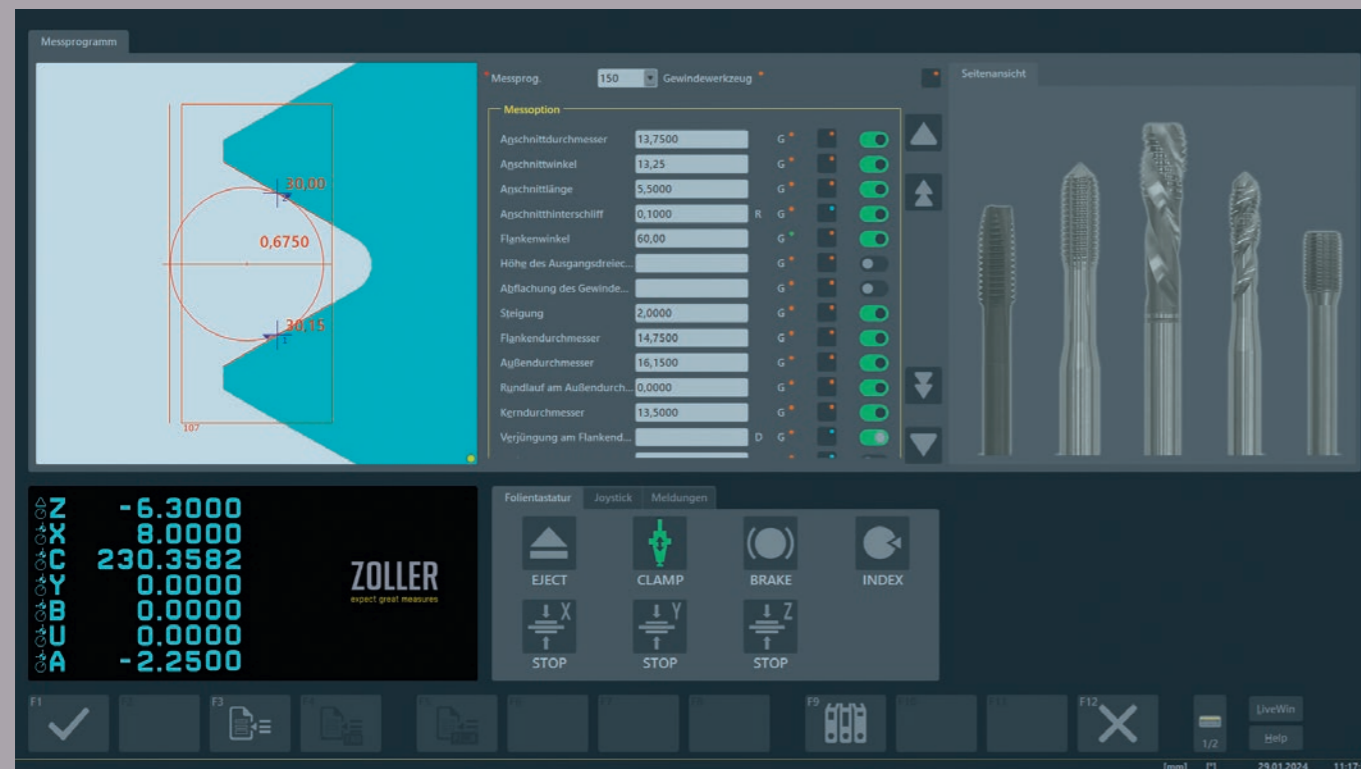
ZOLLER-Gewindemessprogramm – für metrische ISO, ANSI und Whitworth-Rohrgewinde
