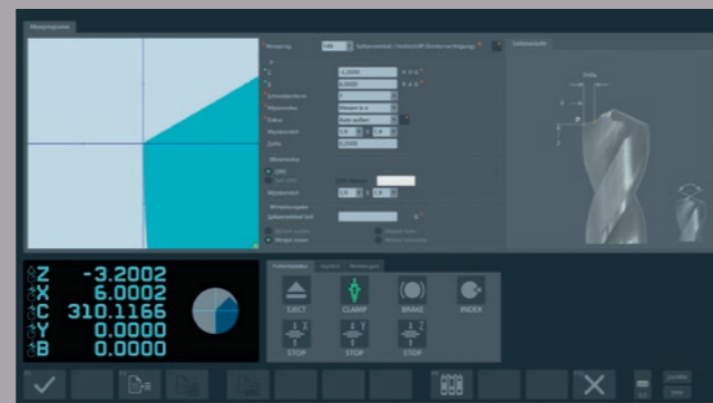
Spitzenwinkel mit Hohlschliff – wird an Bohrwerkzeugen sowie an hohlgeschliffenen Werkzeugschneiden vom Startpunkt (Außendurchmesser) bis zur Werkzeugspitze oder dem definierten Endpunkt durch Konturverfolgung ermittelt.
