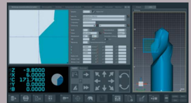
**ZOLLER »caz«** – das virtuelle Messgerät für den PC-Arbeitsplatz zur externen Anlage des Prüf- und Messablaufes inkl. Messprogrammen, Sollwerten und Toleranzen anhand des 3D-Modells vom Werkzeug noch vor dessen Fertigung.
