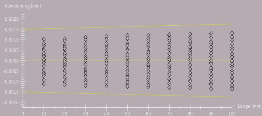
**Eindimensional** – nach VDI/VDE 2617,  $E_x = 1,5 \mu\text{m} + (L/300 \text{ mm}) \mu\text{m}$
