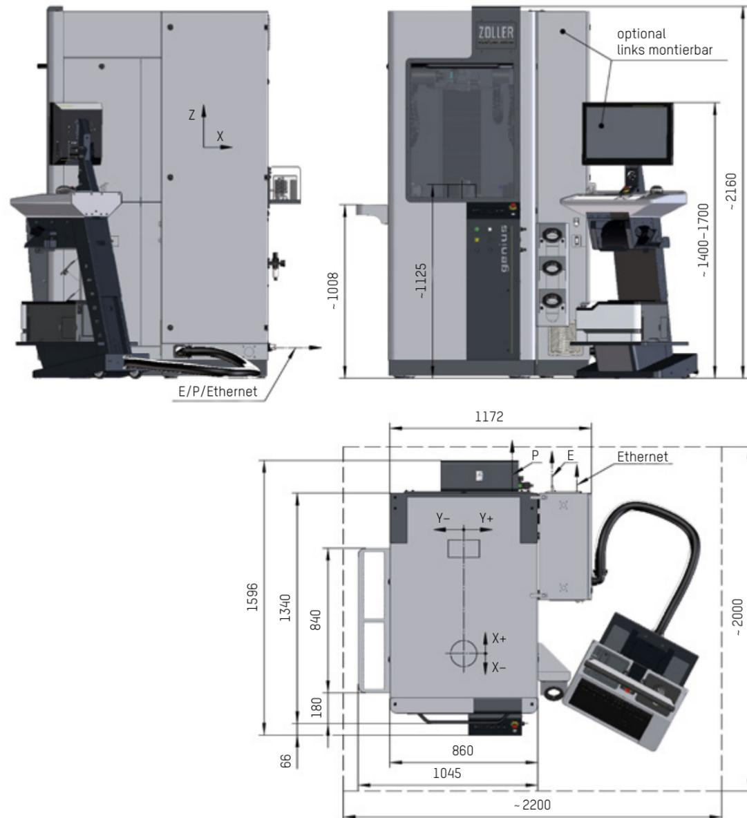
Hinweis: P Luftanschluss, Ø 6 E Elektroanschluss Aufstellmaße in mm
