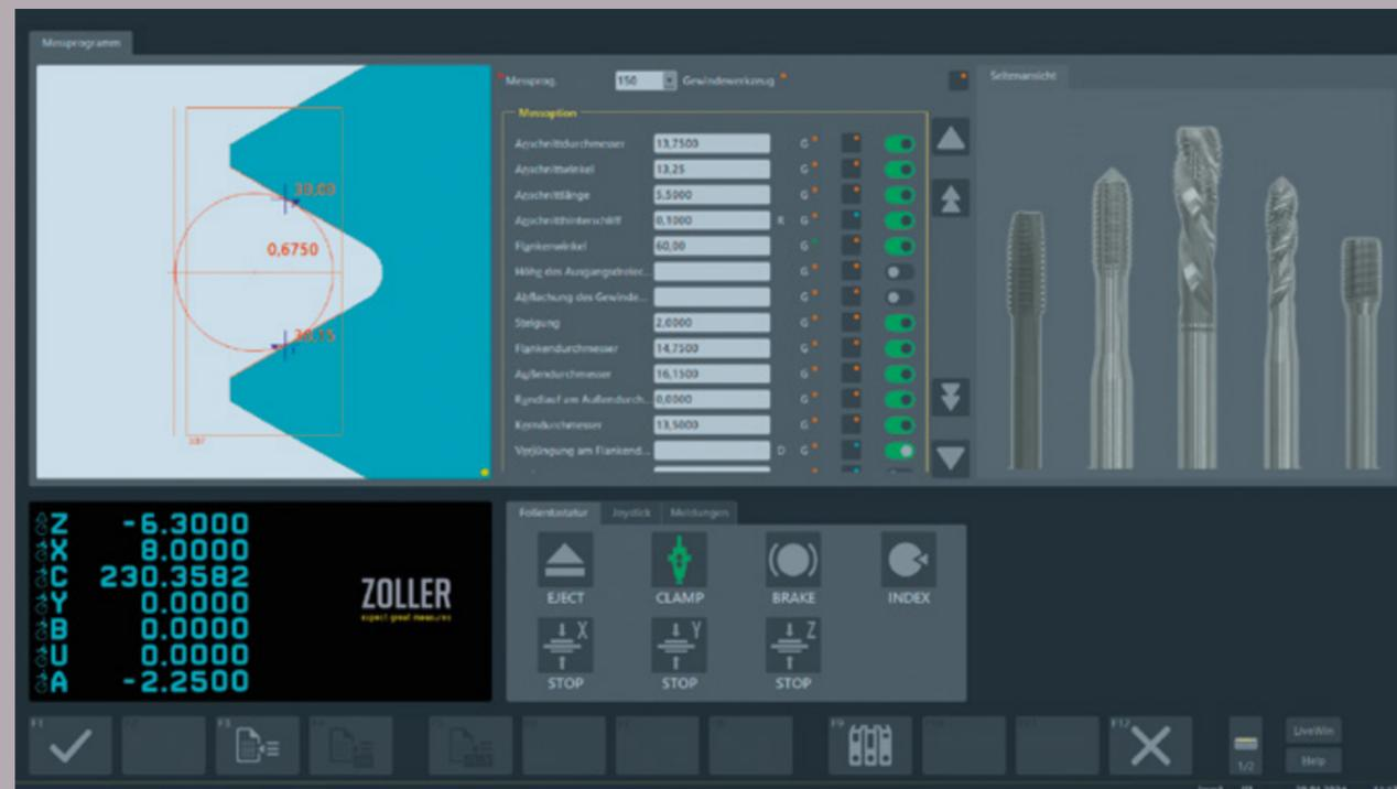
ZOLLER-Gewindemessprogramm – für metrische ISO, ANSI und Whitworth-Rohrgewinde
