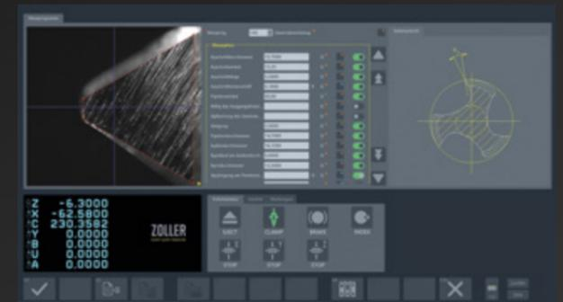
**Messtechnik Gewindewerkzeuge** – speziell für die Anforderungen an Gewindewerkzeugen entwickelte Messtechnik ermöglicht die vollautomatische Vermessung im Durch- und Aufsicht aller relevanten Parameter von Gewindebohrern, -fräsern, und -formern.
