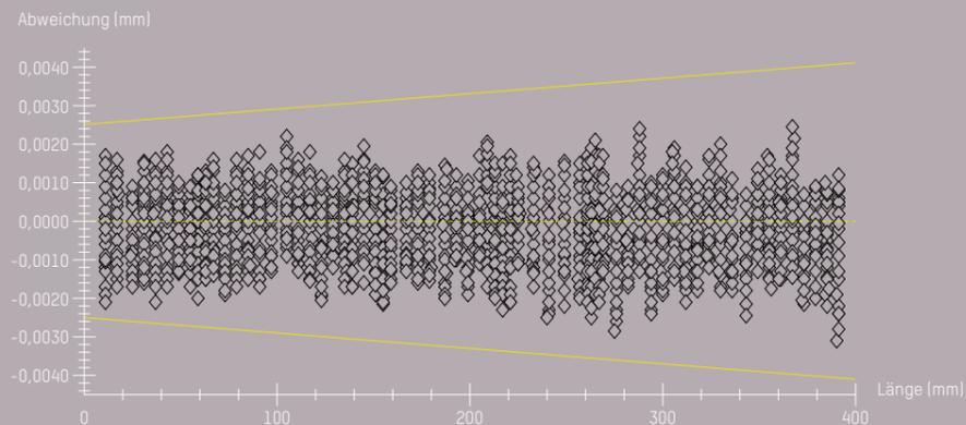
**Zweidimensional** – in Anlehnung an die DIN EN ISO 10360,  $E_{xy} = 2,5 \mu\text{m} + (L/250 \text{ mm}) \mu\text{m}$
