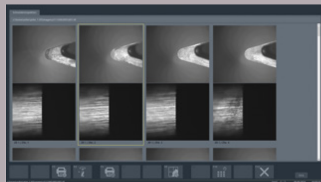
Messprogramm 482 – Übersicht der aufgenommenen Schneidenbilder inklusive Messfunktion zur Verschleißbestimmung.
