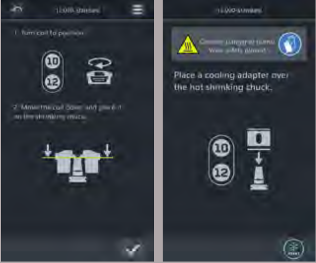
逐步引导 — »pilot« 在整个热缩配合过程中明确提示何时执行哪个步骤。
