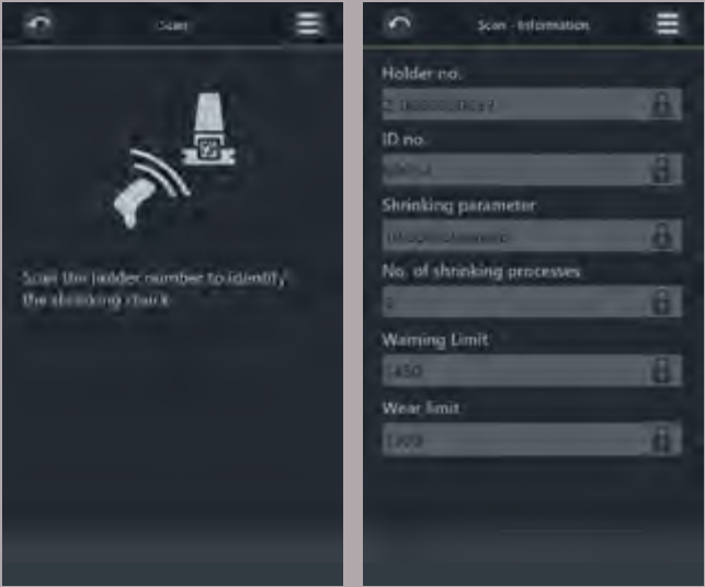
扫描功能 — 自动加载与热缩配合卡盘匹配的所有参数，不限产品制造商。可监控加热过程的次数并显示每个热缩配合卡盘的信息。可以监控加热过程的数量和每个收缩配合卡盘的信息显示。
