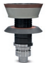
»elephant 2.0« für Schleifscheiben – scannt die Kontur des Schleifscheibenpakets und ermittelt vollautomatisch die einzelnen Schleifscheibentypen. Ohne jegliche Dateneingabe wird das Paket im Anschluss vermessen und im Detail protokolliert. Für Folgemessungen kann das Schleifscheibenpaket gespeichert werden.
