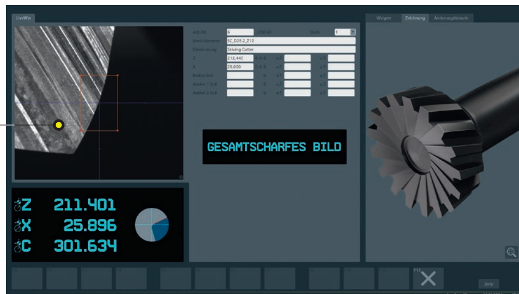
Software Power Skiving Cutter – automatische Vermessung im Aufsicht mit der Werkzeuginspektionskamera inklusive Tiefenbilderzeugung für verzerrungsfreie Messungen und automatischer Regulierung der Beleuchtungsintensität zur optimalen Ausleuchtung der Oberfläche.
