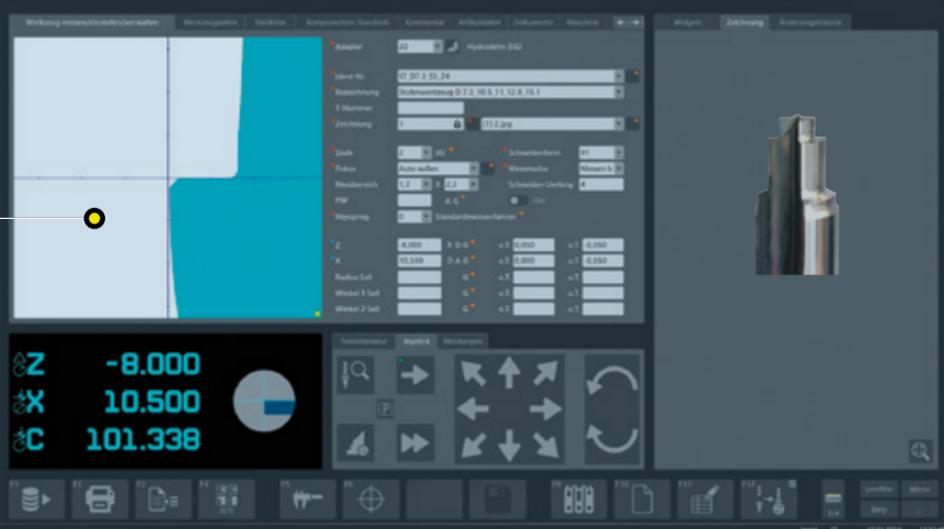
**Software »pilot 4.0«** – mit grafischer Bedienoberfläche für intuitives Arbeiten. Abgespeicherte Messabläufe garantieren eine automatische und bedienerunabhängige Prüfung und Vermessung. Zusätzlich steht für Stichproben die automatische Schneidenformerkennung ohne erforderliche Datenanlage zur Verfügung.
