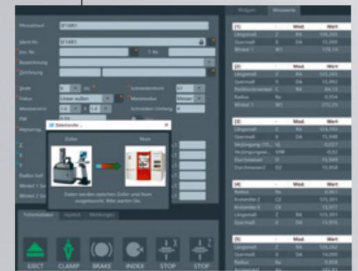
Schnittstellen - das Prüf- und Messgerät empfängt eine Messdatendatei vom Programmiersystem oder der Schleifmaschine und generiert automatisch den Messablauf. Die gemessenen Werkzeug-Ist-Daten werden vom ZOLLER-Prüf- und Messgerät zum Programmiersystem oder an die Maschinensteuerung übertragen, wo das NC-Programm für die Serienfertigung optimiert wird.
