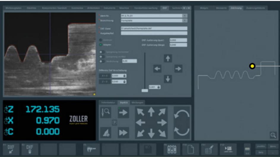
**DXF-Konturprojektion »telesto«** – Einblendung einer DXF-Datei im Auf- und Durchlicht als Sollkontur, um die Werkzeugkontur mit dieser einfach und schnell zu vergleichen.
