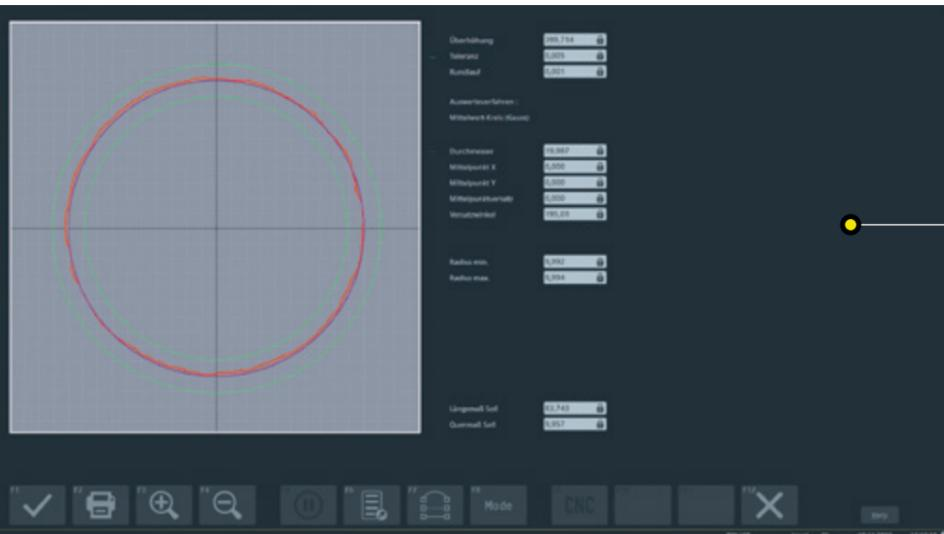
**Rundlaufprüfung 360°** – um den Rundlauf an kreisförmigen Flächen (z. B. Werkzeugchaft) automatisch zu ermitteln und den gesamten Konturverlauf grafisch auszuwerten. Diese Funktionalität ist gleichzeitig Basis für die automatische Rundlauf- und Taumelkompensation.
