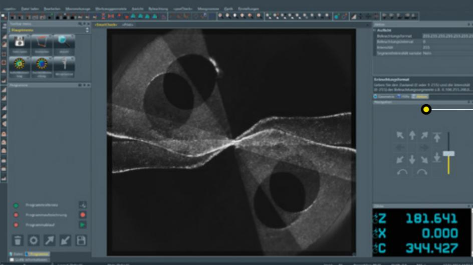
**Werkzeuganalyse »metis«** – die Einblendung eines vom Masterwerkzeug auf Knopfdruck gespeicherten und transparenten Referenzbildes ermöglicht den schnellen optischen Vergleich des zu prüfenden Werkzeugs mit dessen Sollgeometrie.
