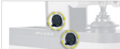
**Y-Achse** – die optionale, CNC-gesteuerte Linearachse zum Messen von aus der Mitte liegenden Schneiden an Dreh- oder Multifunktionswerkzeugen.
