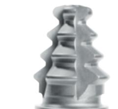
**Konturkorrektur »coCon«** – nach dem Scan der Werkzeugkontur erfolgt anhand der Soll-DXF-Datei die automatische Berechnung der Konturkorrektur von erodierten oder geschliffenen Formwerkzeugen. Die Ausgabe der neuen Kontur erfolgt im DXF-Format.
