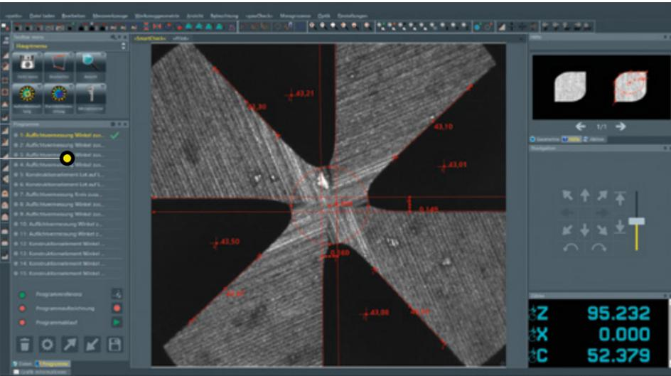
**»metis«-Generator** – zur Erstellung von vollautomatischen Messabläufen im Auf- und Durchlicht, inklusive der Berechnung von Schnittpunkten, Abständen, Winkeln und vielem mehr.
