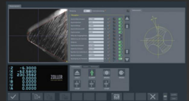
**Messtechnik Gewindewerkzeuge** – speziell für die Anforderungen an Gewindewerkzeugen entwickelte Messtechnik ermöglicht die vollautomatische Vermessung im Durch- und Aufricht aller relevanten Parameter von Gewindebohrern, -fräsern, und -formern.
