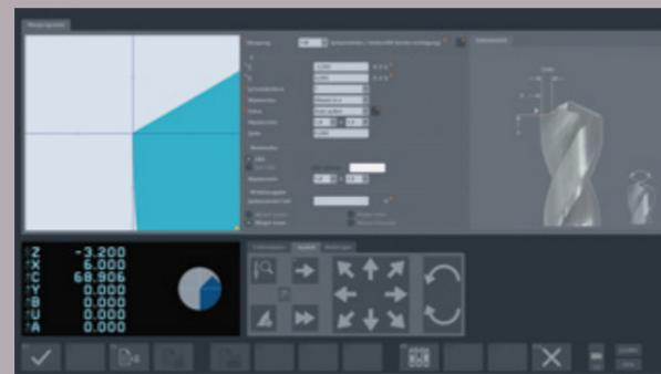
**Spitzenwinkel mit Hohlgeschliff** – wird an Bohrwerkzeugen sowie an hohlgeschliffenen Werkzeugschneiden vom Startpunkt (Außendurchmesser) bis zur Werkzeugspitze oder dem definierten Endpunkt durch Konturverfolgung ermittelt.
