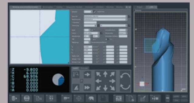
**ZOLLER »caz«** – das virtuelle Messgerät für den PC-Arbeitsplatz zur externen Anlage des Prüf- und Messablaufes inkl. Messprogrammen, Sollwerten und Toleranzen anhand des 3D-Modells vom Werkzeug noch vor dessen Fertigung.
