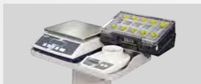
Bilancia utensile, bilancia di precisione e set di viti per equilibratura su un pratico piede di appoggio
