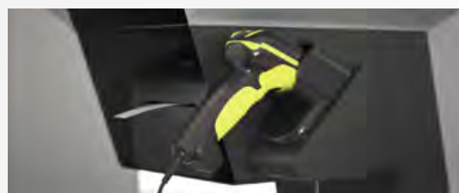
分離操作ユニット «cockpit» でスキャナーによりツールIDを取得
