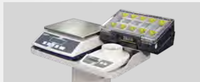
Весы для инструмента, прецизионные весы и комплект балансировочных винтов на практической стойке
