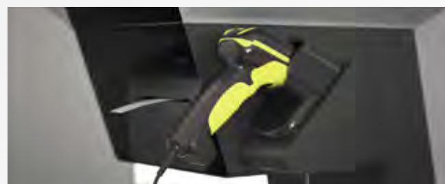
Идентификация инструмента с помощью сканера
