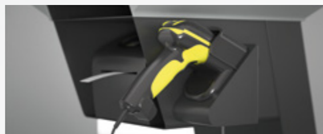
Werkzeugidentifikation per Scanner an der Bedieneinheit »cockpit«
