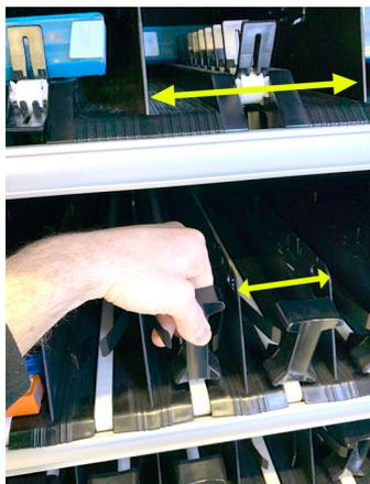
Durch das Einsetzen bzw. Entnehmen der Trennleisten an den Fachböden können die Fachebenen im »twister« in unterschiedlich breite Produktreihen eingeteilt werden. Bei Bedarf können die Ausschiebmotoren in jeder Reihe einzeln entnommen werden.
