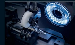
Das Inspektionsgerät **»pomBasic«** prüft Werkzeuge sekundenschnell an bis zu 70 Werkzeugparametern. Einlegen, anfahren, messen.
