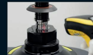
Die **Identifikation** der gemessenen Werkzeuge und Schleifscheiben mit **»zidCode«** startet den automatischen Datentransfer an die Schleifmaschine.
