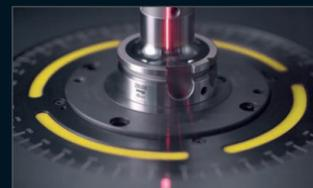
Mit optimal und **hochpräzise gewuchten Schleifscheiben** erreichen Sie längere Spindellaufzeiten.
