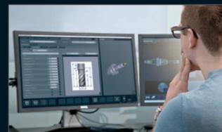
Generieren des Messablaufs am externen Arbeitsplatz mithilfe des Softwaremoduls **»caz«**, das ein Messgerät simuliert.
