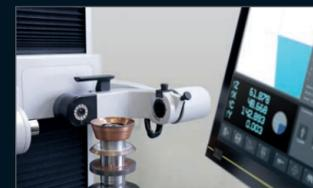
Vermessen des Schleifscheibenpakets mit dem ZOLLER-Messgerät führt zu µm-genauen, zentral hinterlegten Daten für den weiteren Prozess.
