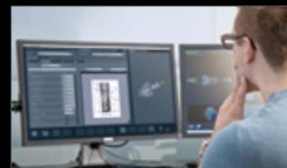
Genere la **secuencia de medición** en la estación de trabajo externa mediante el módulo de software »caz« que simula un dispositivo de medición.
