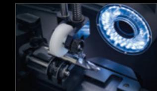
El dispositivo de inspección **»pomBasic«** comprueba hasta 70 parámetros de las herramientas en cuestión de segundos. Insertar, aproximar, medir.
