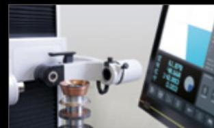
La mesure du paquet de meules avec l'appareil de mesure de ZOLLER conduit à des données précises au µm, déposées de manière centralisée pour la suite du processus.
