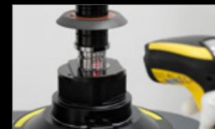
L'identification des outils et des meules mesurés avec **»zidCode«** démarre le transfert automatique des données vers l'affûteuse.
