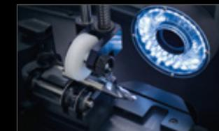
L'appareil d'inspection **»pomBasic«** contrôle les outils en quelques secondes sur jusqu'à 70 paramètres d'outils. Insérer, aborder, mesurer.
