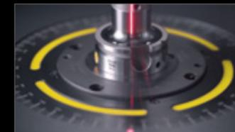
Der **Wuchtadapter mit Mittenversatz** ist mit Zweipunkanlage und Druckstück konstruiert und sorgt so für große und besser messbare Sensorsignale.
