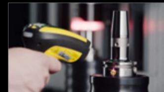
Die Scan-Funktion der Software **»pilot«** ermöglicht eine sichere Auswahl des passenden Schrumpfparameters per Scan der Halternummer.
