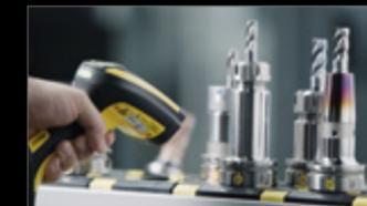
Mit **ZOLLER »zidCode 4.0«** übertragen Sie sämtliche digitalen Werkzeugdaten an die CNC-Steuerung – ohne Tipp- und Übertragungsfehler.
