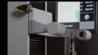
Durch Einscannen des **ZOLLER »zidChip«** am Einstell- und Messgerät werden die Werkzeugdaten direkt abgerufen und der Messablauf kann starten.
