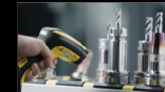
Con **ZOLLER »zidCode 4.0«** usted transmite todos los datos digitales de la herramienta al control CNC - sin teclear y errores de transmisión.
