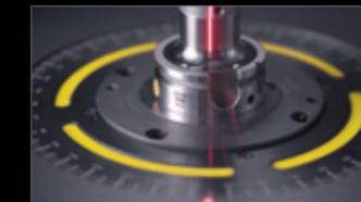
El adaptador de equilibrado con desplazamiento respecto al centro esta diseñado con un sistema de dos puntos y una pieza de presión. Estos dan lugar a una señal de sensor grande y de mejor medición.
