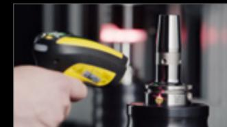
La función de escaneado del software **»pilot«** permite una selección segura del parámetro de contracción adecuado escaneando el número de soporte.
