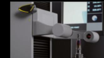
Al escanear el **ZOLLER »idChip«** en el dispositivo de ajuste y medición, se consultan directamente los datos de la herramienta y puede iniciarse el proceso de medición.
