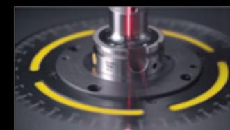
L'adaptateur d'équilibrage a deux points et une pièce de pression. Cela permet un signal de capteur plus grand et mieux mesurable.
