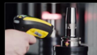
La fonction de numérisation du logiciel **»pilot«** permet une sélection en toute sécurité du paramètre de frettage approprié en scannant le numéro sur logement de frettage.
