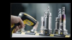
Con **ZOLLER** »**zidCode 4.0**« si trasmettono tutti i dati digitali dello strumento al il controllo CNC - senza digitare e errori di trasmissione.
