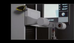
Con la scansione dell'»idChip« ZOLLER sul dispositivo di impostazione e misurazione, i dati dell'utensile vengono richiamati direttamente e il processo di misurazione può iniziare.
