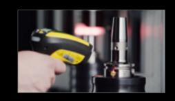
La funzione di scansione del **software** »pilot« consente una selezione sicura del parametro di calettamento idoneo, tramite scansione del numero di supporto.
