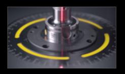
L'adattore di equilibratura con center offset e realizzato con un inserto a due punti e un elemento di spinta. Questo permette che il segnale sensore sia maggiormente misurabile.
