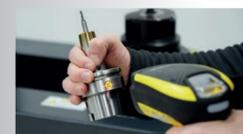
Escaneando el »idChip« con ZOLLER »zidCode 4.0« en el presetter, los parámetros de medición se cargan automáticamente y las herramientas se miden inmediatamente en cualquier momento.
