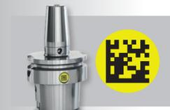
Cuando se escanea el código de identificación de la herramienta, la máquina CNC recibe todos los datos necesarios de la herramienta a través de la red.
