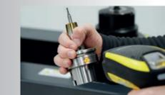
Con la scansione del »idChip« con ZOLLER »zidCode 4.0« sulla macchina di regolazione, i parametri di misura vengono caricati automaticamente e gli utensili vengono misurati immediatamente in qualsiasi momento.
