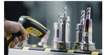
Bild 03: Mit »zidCode 4.0« und dem ZOLLER »idChip« kommunizieren die Werkzeuge direkt mit der CNC-Maschine.
