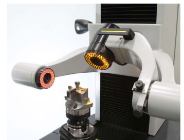
Bild 03: Mit der hochwertigen und industriegerechten Optik werden im »smartCheck« Werkzeuggeometrien an der Außenkontur im Durchlicht automatisch und µ-genau vermessen. Im Auflicht können manuelle Messungen durchgeführt werden – über innovative Softwarepakete sogar automatisiert. Die hochauflösenden Schneidenbilder eignen sich hervorragend zur Dokumentation.
