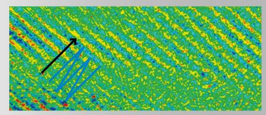
Représentation des stries de la surface d'un outil Les points jaunes représentent les bosses, les points bleus les creux. La ligne bleue indique la longueur mesurée, la flèche montre la rugosité orthogonalement par rapport aux stries.
